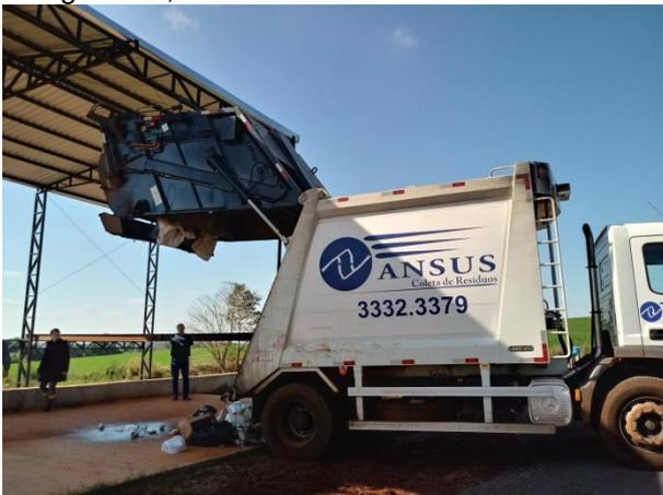
Figura 34: Teste de descarga; 9 de ago de 2018;
