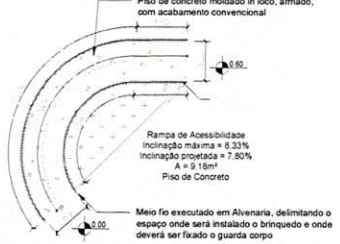
10 DET. 04 - Rampa de Acessibilidade - Av. Cel. Dico
